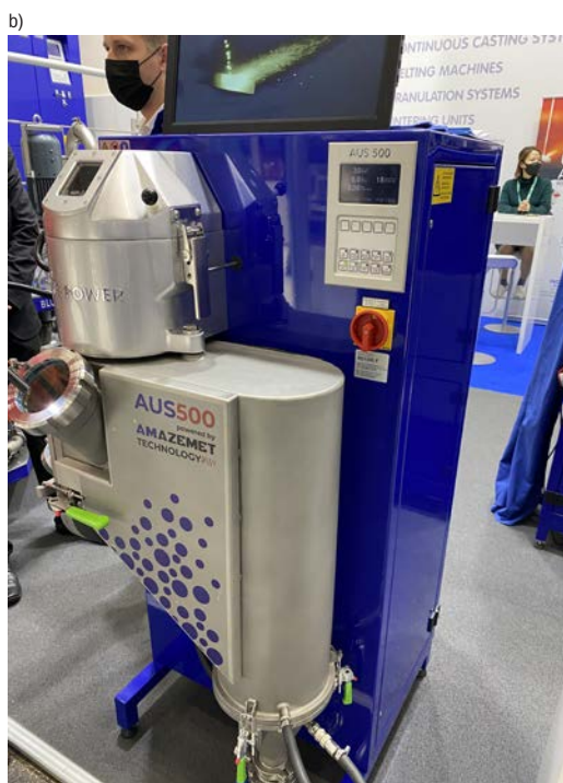
5a, 5b. 5. Proszki metali wytworzone polską technologią atomizacji ultradźwiękowej (a) oraz urządzenie Blue Power Casting Systems wykorzystujące polską technologię atomizacji ultradźwiękowej (b)
